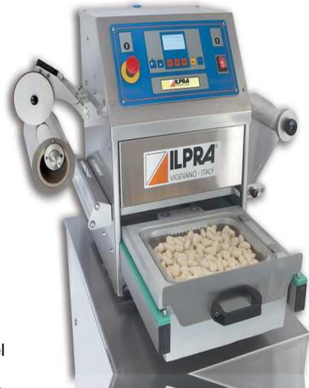
En la versión vacío/gas la máquina está dotada de instalación de vacío completo con una bomba de 21 metros cúbicos. Este modelo semiautomático de sobremesa puede introducirse fácilmente en laboratorios artesanales, supermercados y restaurantes. **El cambio de formato es simple y rápido sin necesidad de herramienta.**
