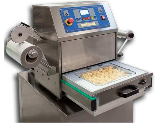
Realizada en acero inoxidable y aluminio anodizado, está perfectamente adaptada para trabajar con una tasa alta de humedad. Con protección IP 44 cumple con las normativas comunitarias a nivel de protecciones.
